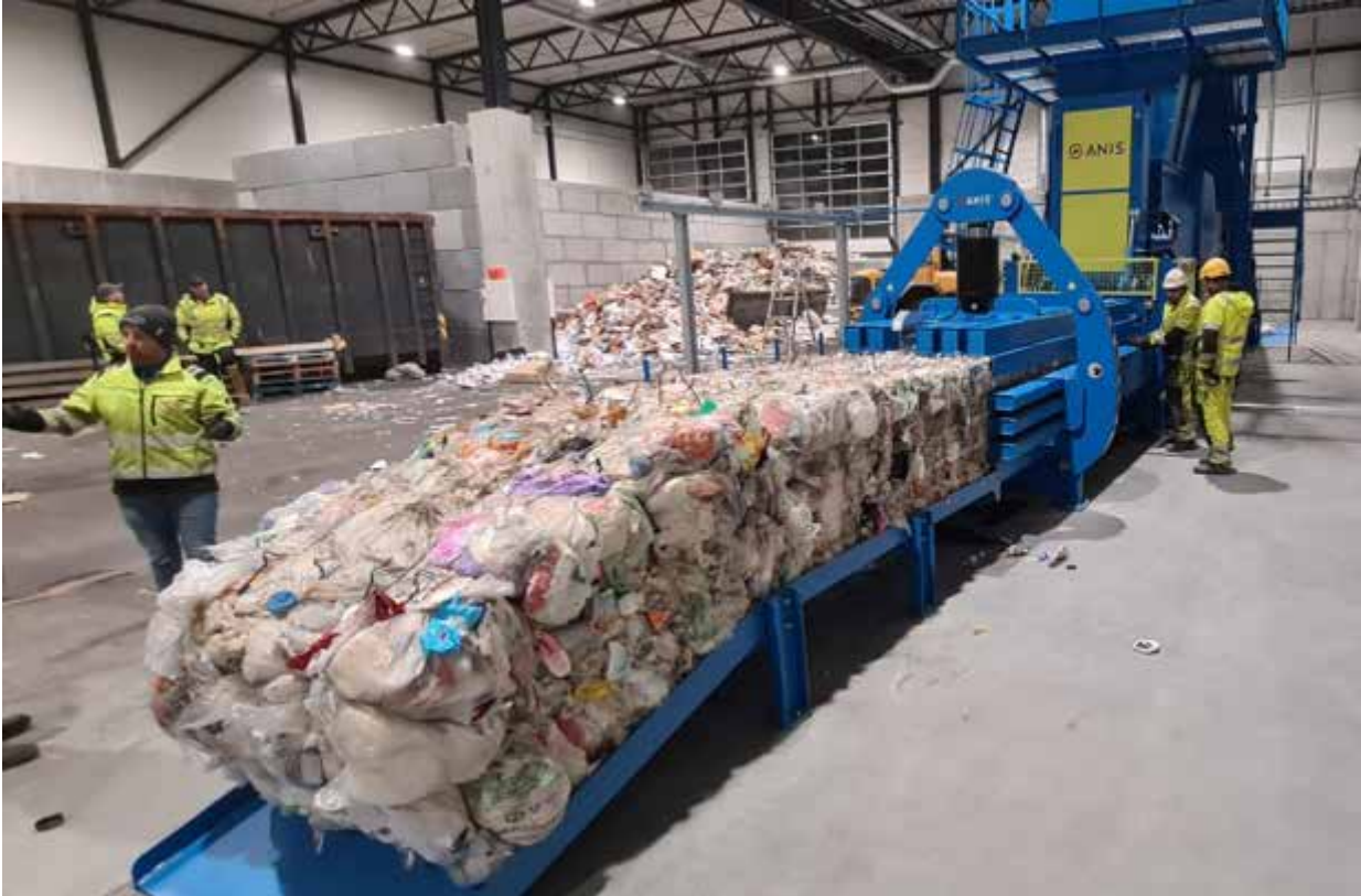
Testing av kanalpresse på Melsgjerdet i slutten av november 2022.
